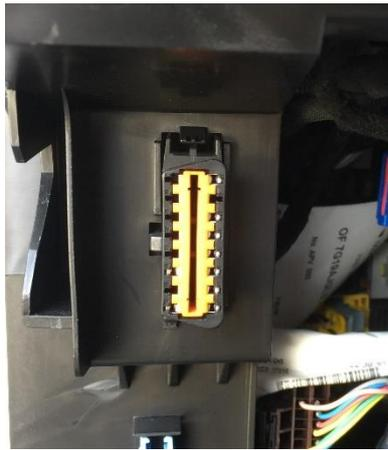
→ Si l'accessibilité de la prise OBD du véhicule est étroite, dans ce cas, il faut utiliser la rallonge fournie.
